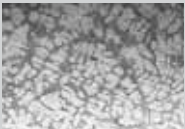
フローフォーミング前の 鋳造素材断面
